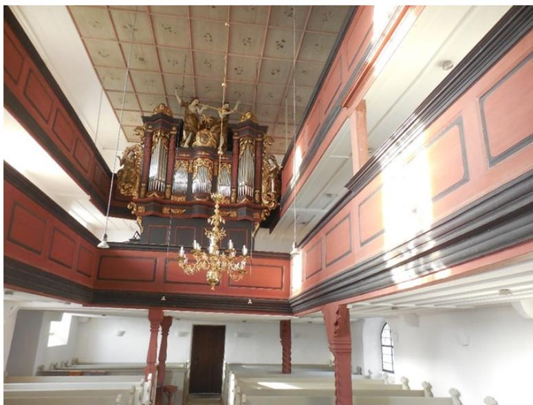
An drei Seiten wurde eine südlich bis an das östliche Fenster herumgeführte Holzempore errichtet. Ein zweites, südlich und westlich schmäleres Emporengeschoß wurde mittels Eisenstangen an der Dachkonstruktion aufgehängt und nur nördlich später auf der unteren Empore abgestützt. Der Fußboden wurde mit Sandsteinplatten belegt. Auf einer Holzsäule im Kirchenschiff sind die Jahreszahl 1611 und die Buchstaben HPGS eingritz, einmal lesbar und einmal spiegelverkehrt.
